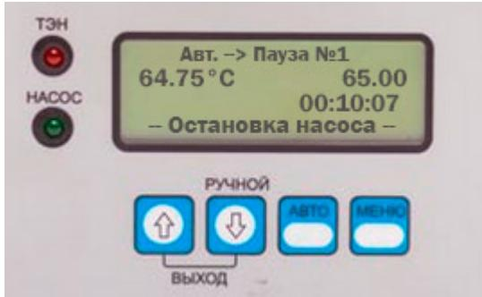
Когда начинается период отдыха – звучит звуковой сигнал, и на дисплее отображается индикация состояния насоса. Для каждого шага запускается таймер обратного отсчёта, когда температура достигает её заданного значения. За 5 секунд до конца шага будет звучать уведомляющий сигнал.
