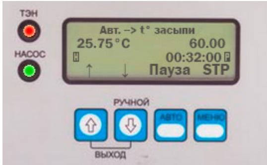
Система начинает нагревание и рециркуляцию воды, и когда достигается температура начала затирания – система входит в состояние паузы/цикла.
