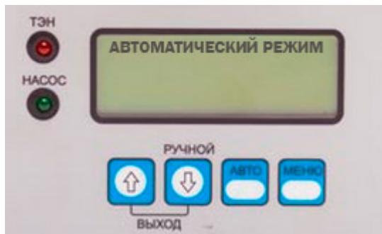
Автоматический режим: Автоматизация является истинным "сердцем" системы, и контроллер функционирует в последовательности всех шагов, ранее сконфигурированных в меню Установок Автоматического Процесса.
