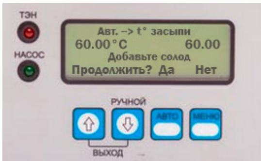
Насос останавливается, в то время как температура поддерживается постоянной. Затем система спрашивает, загружено ли зерно в бункер солода.
