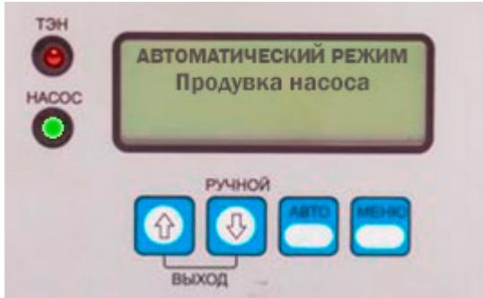
Эта операция полезна, чтобы выгнать пузырьки воздуха вокруг контуров и крыльчаток насоса. В конце этой фазы запускается насос, и вода рециркулирует.
